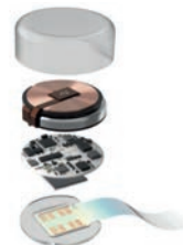
Rysunek 5.23. Link — chip Neuralink implantowany na zewnątrz czaszki [36]
